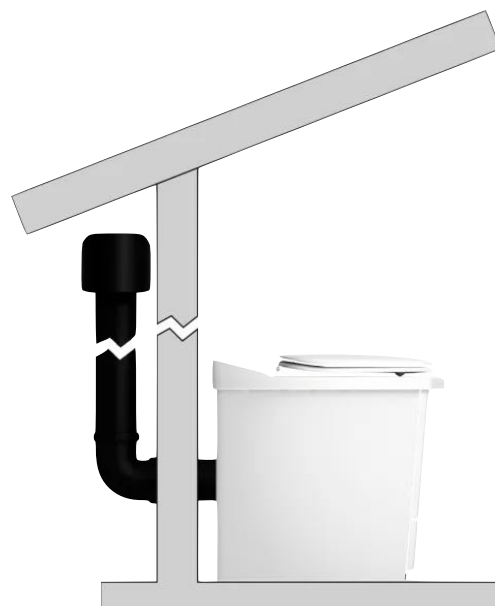
REKOMMENDERAR ATT GÅ UPP NÅGON METER MED RÖRET, DET GÅR UTMÄRKT ATT STANNA MED REGNHATTEN INNAN TAKFOT
